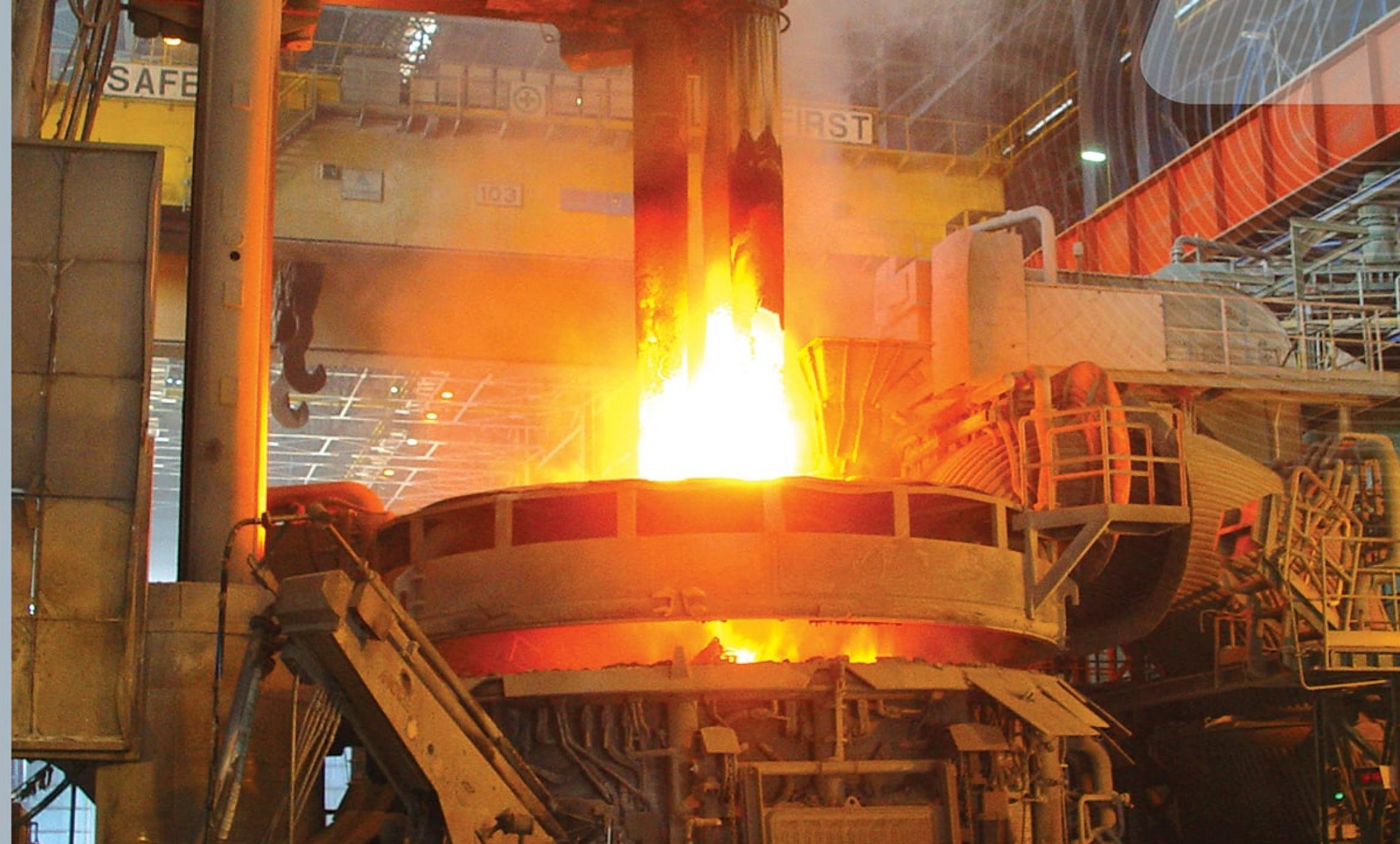
آهن اسفنجی (DRI) ذخیره شده در سیلوهای ذخیره محصول، توسط نوار نقاله (Conveyor Belt) به همراه قراضه (Scrap)، با به کارگیری جریان الکتریسیته ( $120$  MVA) در کوره قوس الکتریکی  $110$  تنی (EAF) به فولاد مذاب تبدیل می شود.
